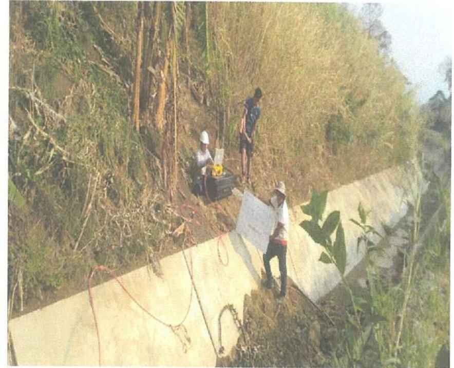
ENSAYO REFRACCIÓN SISMICA EN LA PROGRESIVA 7+460
