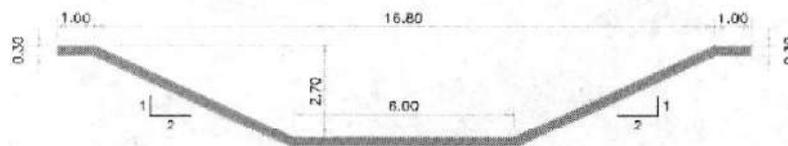
**Rápida N°1.-** Esta estructura hidráulica forma parte de la obras conexas del canal de contingencia, su función es, evacuar el flujo proveniente del canal de contingencia a través del talud del Dique N°1 en la figura N° A.1.6, se detalla la sección hidráulica, ver plano CSL-130900-1-AC-03 (7-7). Figura N°A.1.6 Sección geométrica de Rápida N°1:
