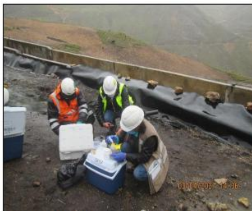
Fotografía N° 63 179 : Se observa la toma de muestras en el punto especial ESP-ARI-2, que corresponde a los discurrimientos de agua de la cancha de material estéril EJ-04 que llegan al canal revestido con geomembrana, ubicado al pie de la referida cancha ubicado en las coordenadas UTM WGS 84 N: 8 568 535, E: 520 876.
