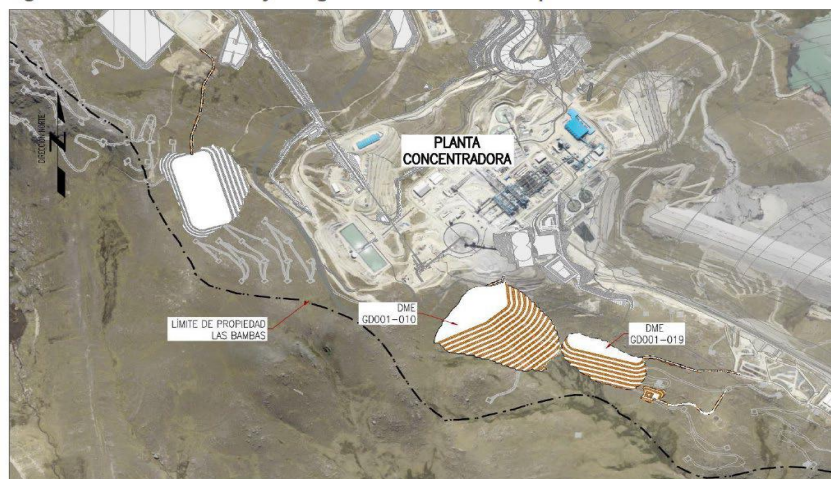
Figura 2.11-318: Ubicación y Arreglo General – Nuevos Depósitos de material excedente
