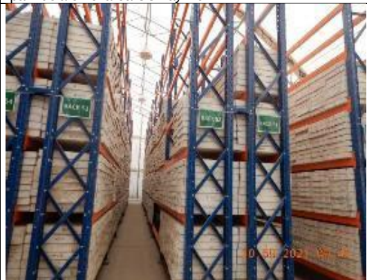
Fotografía N° 121 (DSCN4824.JPG): Vista del almacenamiento de testigos en cajas, colocados en estante (rack) dentro de uno de los iglú, en el área de CC Lay Down.
