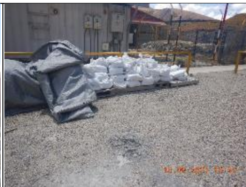
Fotografía N° 143 (DSCN6358.JPG): Vista de costales con muestras de testigo almacenados sobre parihuela a la intemperie.
