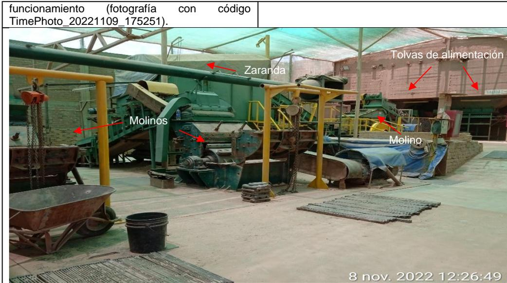
**Fotografía N° 3:** Las tolvas de alimentación, los molinos, la zaranda rotativa y fajas transportadoras, se encuentran apagadas (fotografía con código TimePhoto\_20221108\_122649)
