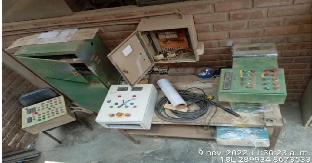
**Fotografía N° 12:** Se observa los paneles eléctricos retirados de las líneas de producción, que controlaban el funcionamiento de los equipos y maquinarias (fotografías TimePhoto\_20221109\_113023).
