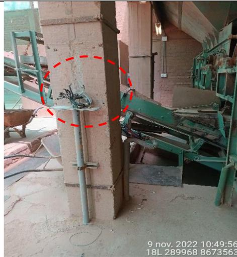
**Fotografía N° 13:** Se observa panel de control desmontado de los molinos, fajas y zarandas (fotografía TimePhoto\_20221109\_104956).
