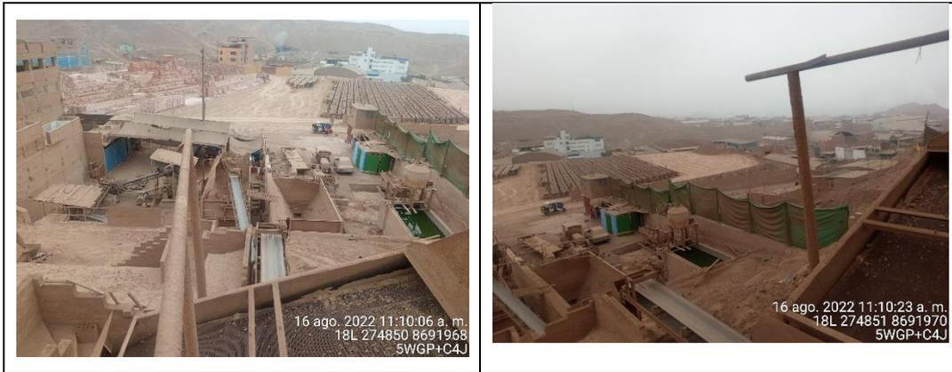
Fotografía N° 3 y 4 (TimePhoto:20220816\_111006 e TimePhoto\_20220816\_111023). Vista de fajas transportadoras que conducen la materia prima desde las tolvas hacia los molinos y luego a la mezcladora. Las fajas se encontraban descubiertas (no contaban con guardas).
