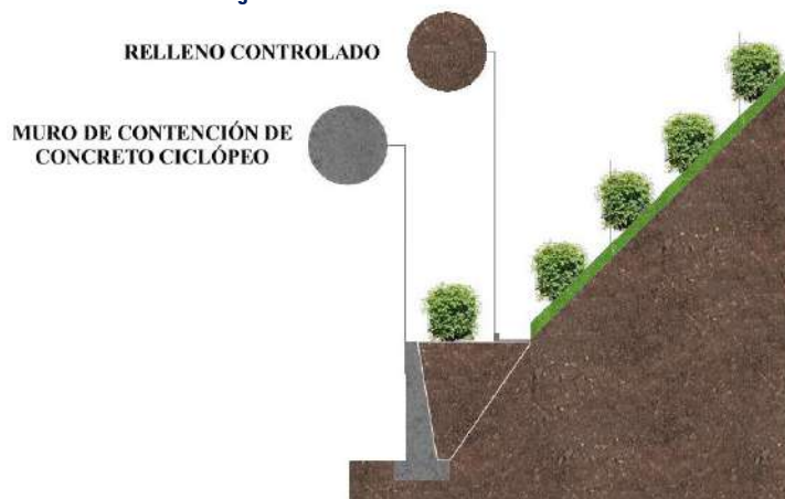
Imagen N° 191: Muro de contención.
