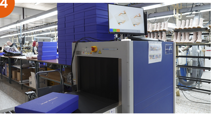
Video: Máquina integrada con visión artificial y rayos X para el control de calidad del calzado
