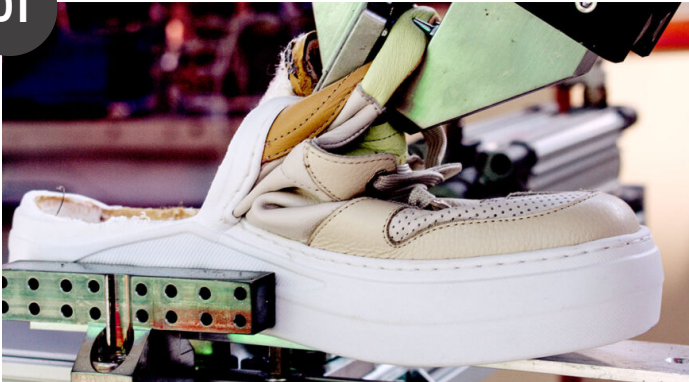
Imagen: Desensamblado de un calzado gracias la fuerza impuesta por un robot
