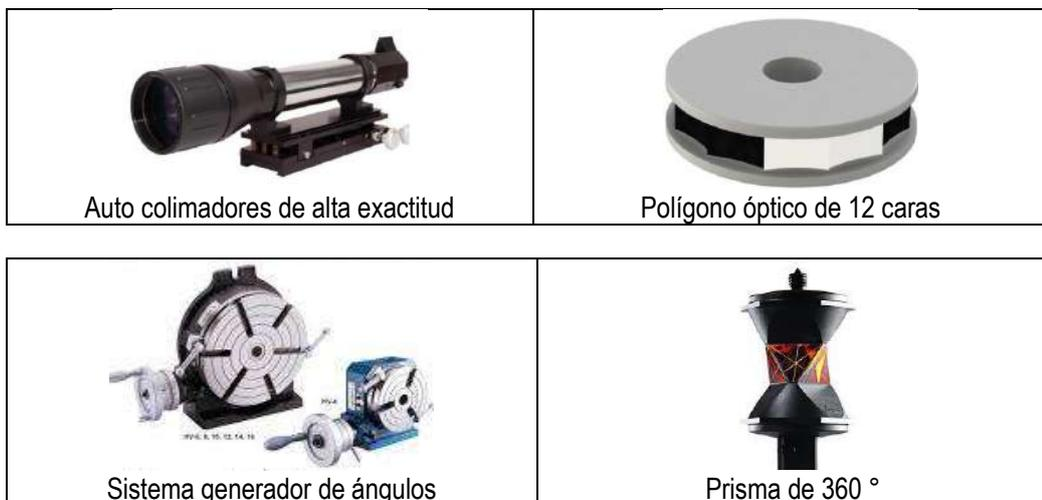
Para la medición de ángulos verticales se requerirá los siguientes equipos.
