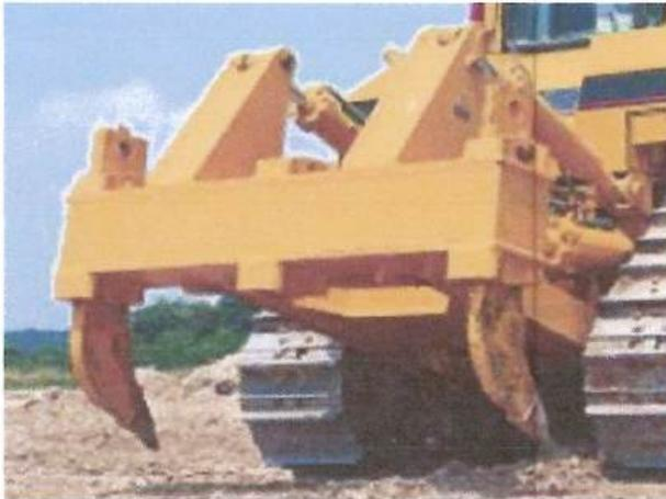
Los desgarradores de un solo vástago y de múltiples vástagos están diseñados para penetrar en los materiales resistentes de forma rápida y desgarrar por completo una variedad de materiales.
