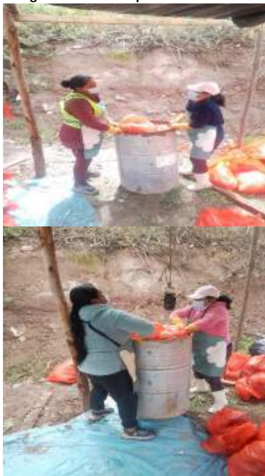
Fotografía 36-39: Compactado de residuos mediante el método de caída libre
