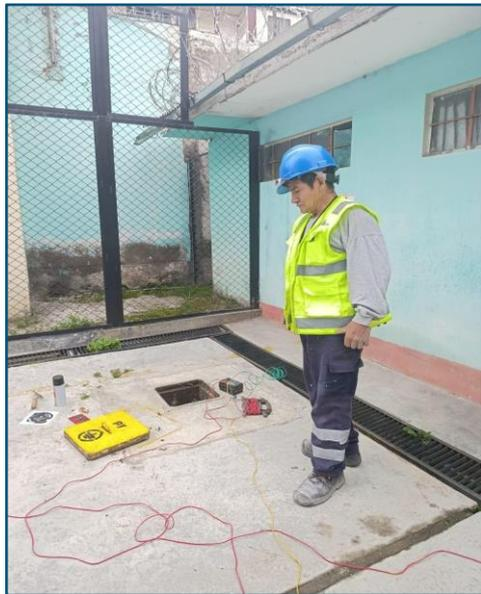
*Pruebas de certificación del cableado de red eléctrico y pozo a tierra*
