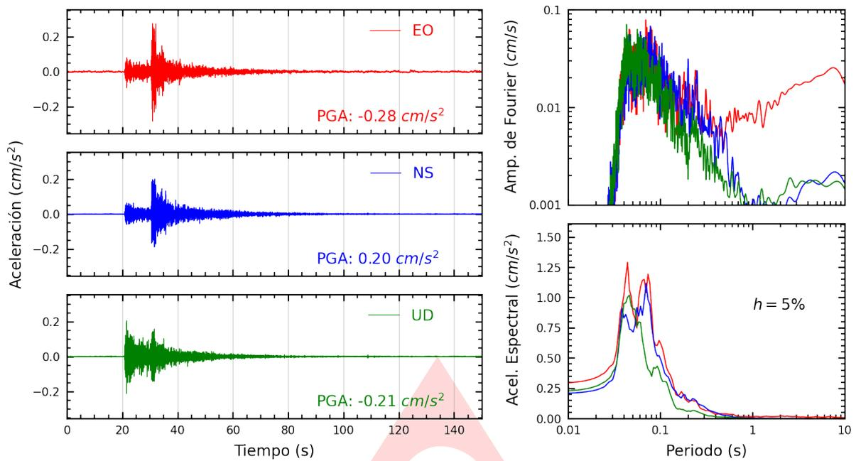
**Figura A.1:** Registros tiempo-historia, espectros de Fourier y de respuesta en las direcciones EO, NS y UD de la estación SCCHI. Sismo de San Pedro De Lloc, Pacasmayo - La Libertad de 2025-04-19, 01:13:44 (Hora local)
