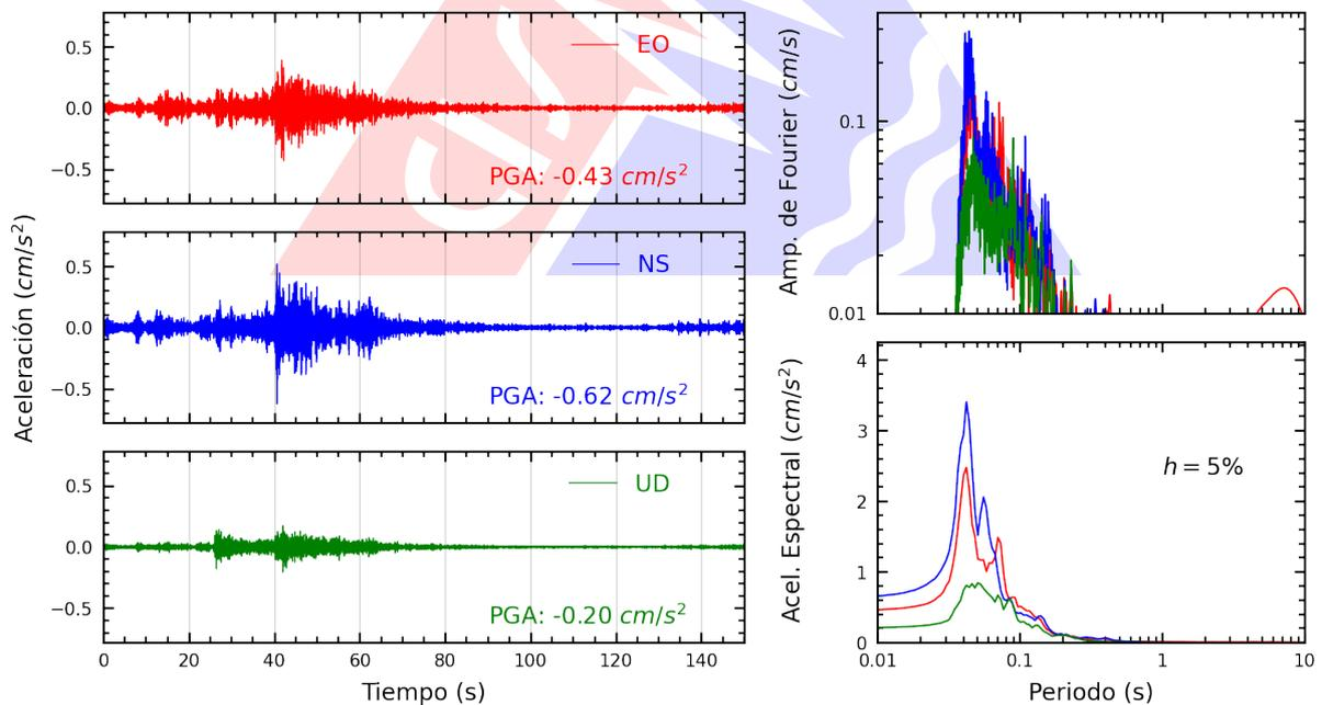
**Figura A.2:** Registros tiempo-historia, espectros de Fourier y de respuesta en las direcciones EO, NS y UD de la estación SCTRU. Sismo de San Pedro De Lloc, Pacasmayo - La Libertad de 2025-04-19, 01:13:44 (Hora local)
