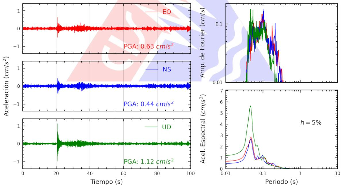
**Figura A.2:** Registros tiempo-historia, espectros de Fourier y de respuesta en las direcciones EO, NS y UD de la estación SCCHO. Sismo de Chosica, Lima - Lima de 2025-05-13, 06:24:55 (Hora local)
