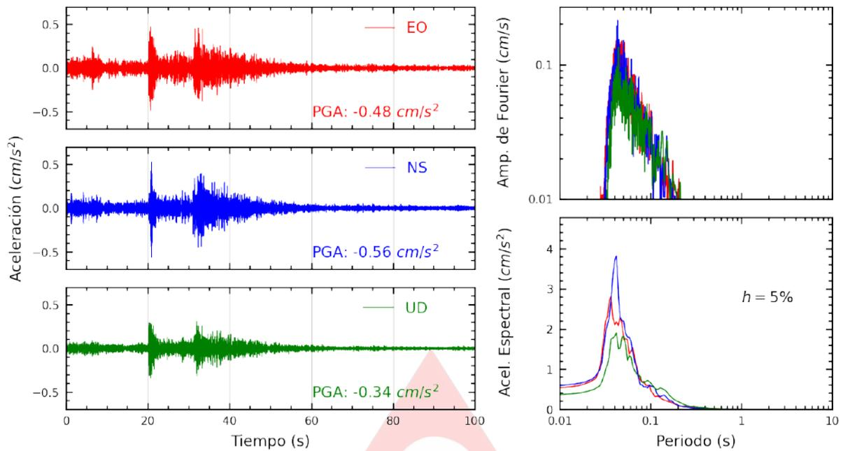
**Figura A.1:** Registros tiempo-historia, espectros de Fourier y de respuesta en las direcciones EO, NS y UD de la estación BORJA. Sismo de Chosica, Lima - Lima de 2025-05-13, 06:24:55 (Hora local)
