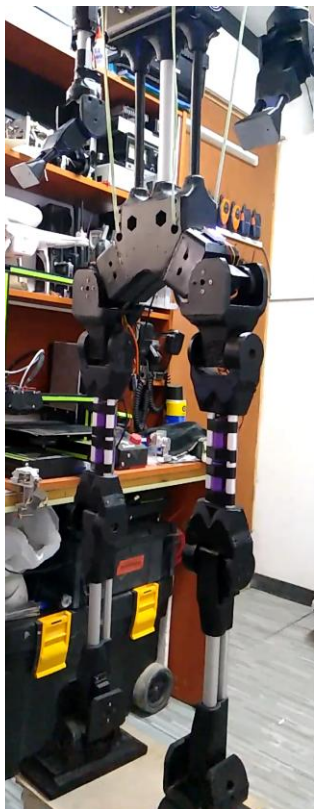
Accionamiento de miembros inferiores y prueba de resistencia estructural
