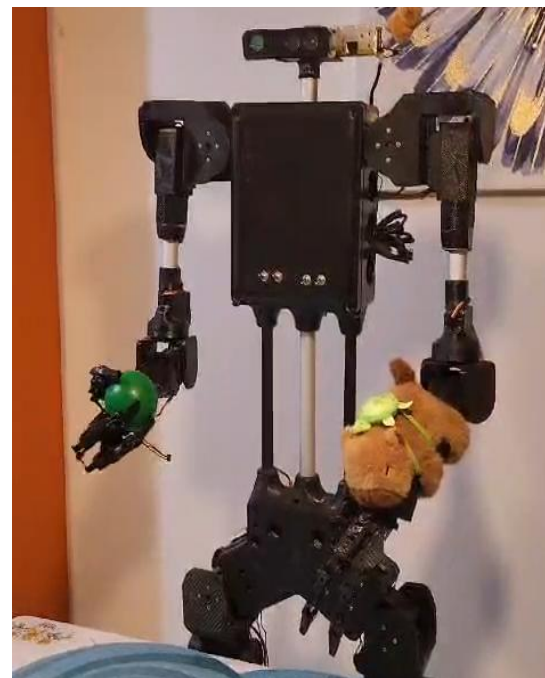
Sujeción de objetos y control coordinado de brazos
