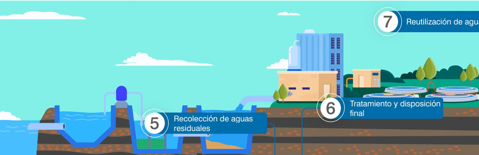
Nuestro sistema de recolección de aguas residuales está compuesto por conexiones de alcantarillado, así como por una red de colectores primarios y secundarios, que en total tiene una extensión de 14,173 km. Además, contamos con cámaras de bombeo de desagües, líneas de impulsión y líneas de conducción que dirigen las descargas hacia las Plantas de Tratamiento de Aguas Residuales.
