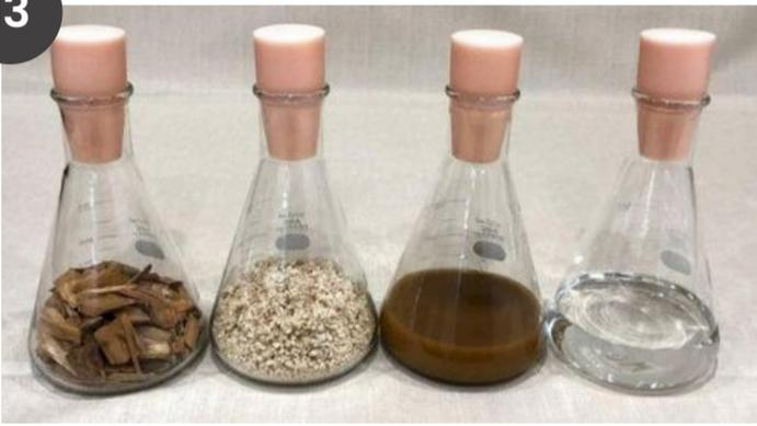
Imagen: Airbus: Astillas de madera, pulpa, líquido de cultivo de fermentación, bioetanol.
