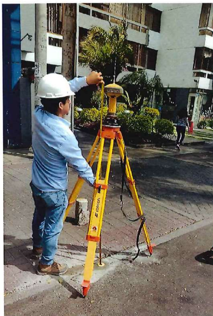
Ilustración 28: Operario midiendo la altura del geodésico en posición
