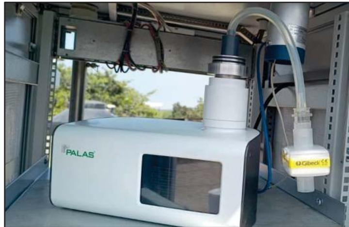
Imagen N° 16. Conexión del filtro HEPA en la entrada del Equipo Fidas Smart 100E
