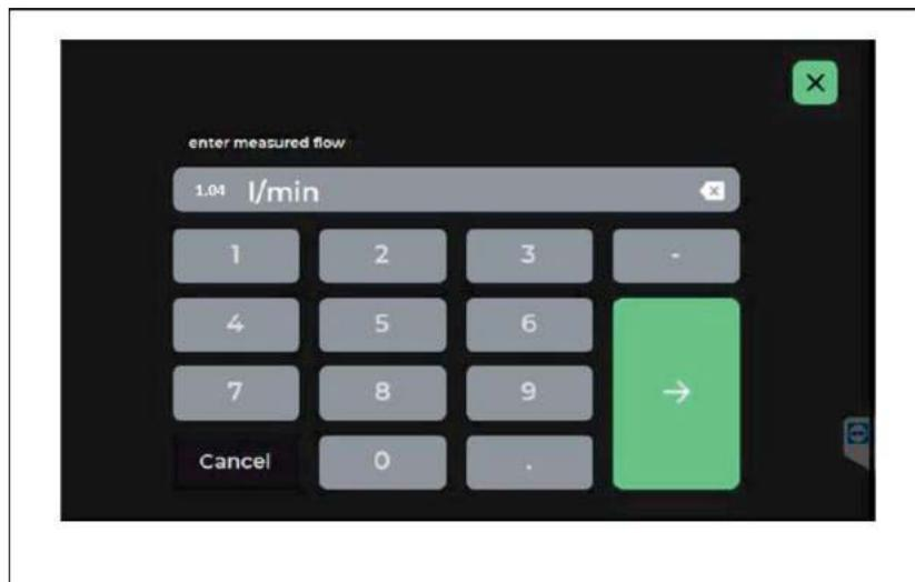
Imagen N° 13. Ingreso de flujo (ajuste) al Equipo Fidas Smart 100E
