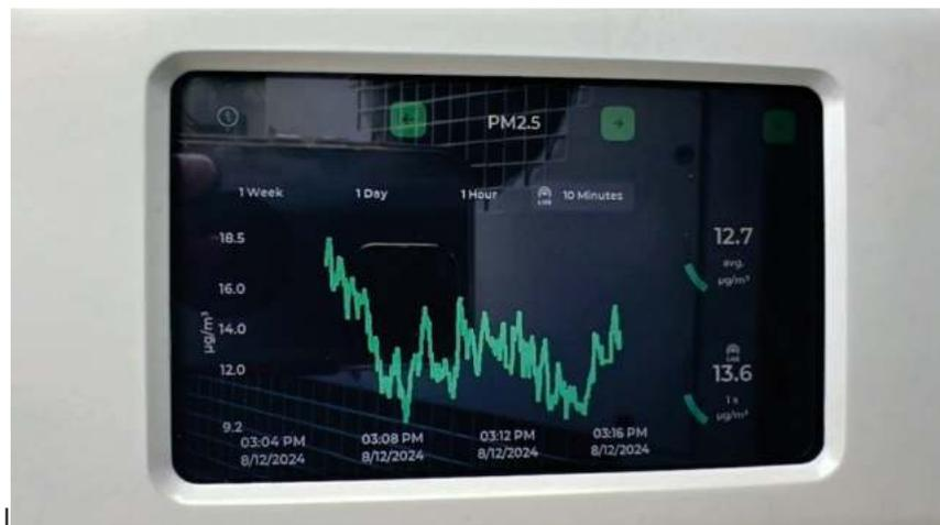
**Imagen N° 06. Panel de control con valores medidos en bloques en el Equipo Fidas Smart 100E**
