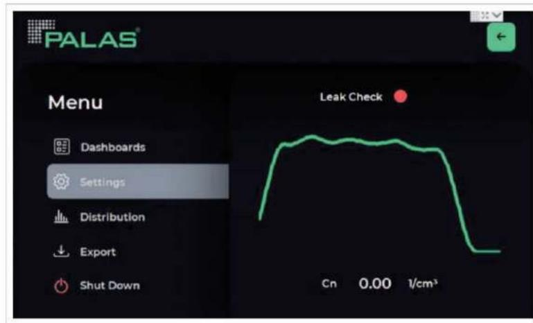
Imagen N° 18. Estabilización de la comprobación de fugas del Equipo Fidas Smart 100E
