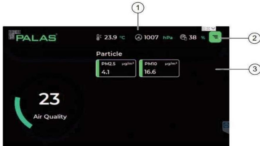
1. Datos meteorológicos: Temperatura del aire, presión del aire, humedad relativa.
