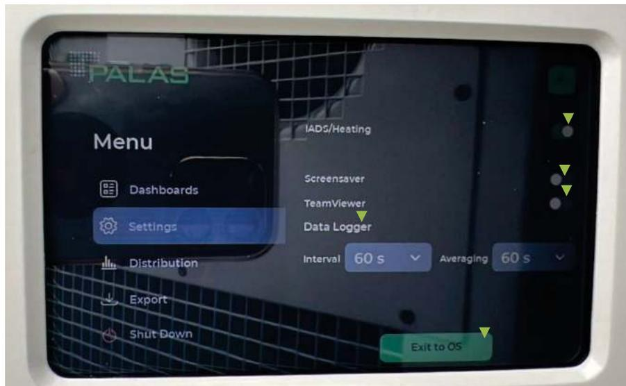
Activa o desactiva la sección de secado IADS compact. Esta característica debe activarse cuando el dispositivo se va a utilizar para mediciones en el exterior (Fidas Smart 100E).
