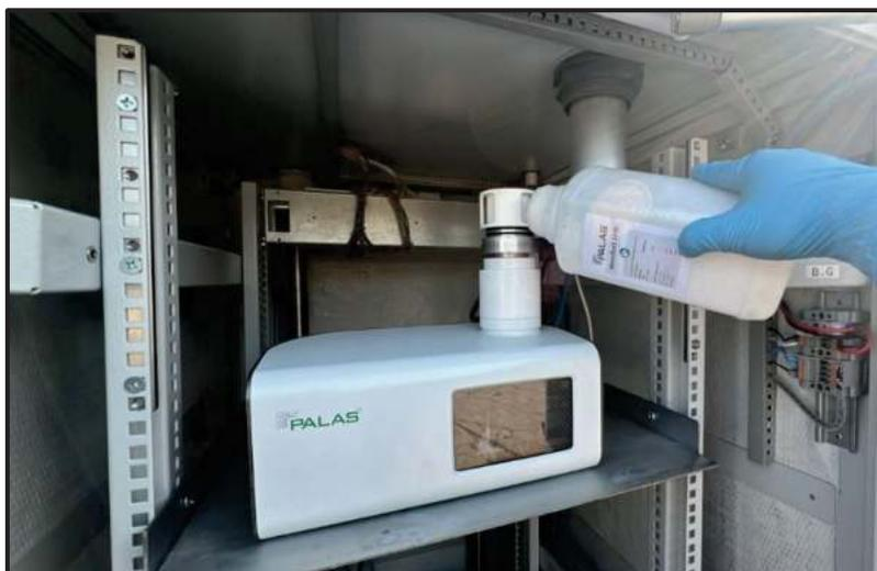
Imagen N° 22. Verificación del Equipo Palas marca Fidas Smart 100E con MonoDust 1500
