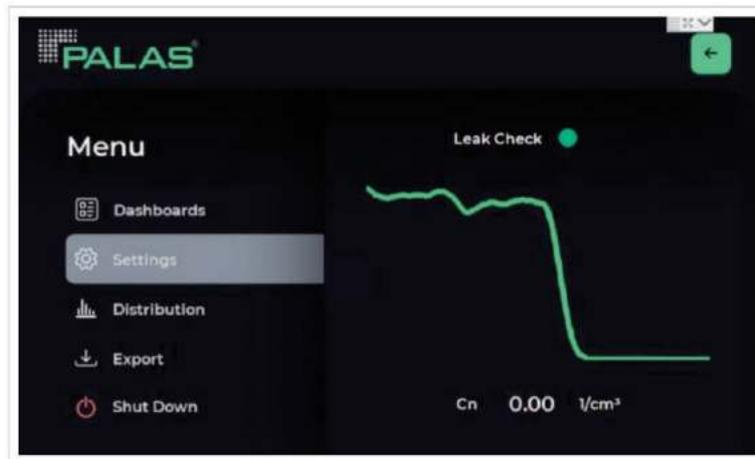
Imagen N° 20. Verificación de fugas aprobada del Equipo Fidas Smart 100E 2.
