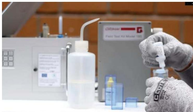
2.6.5. Colocar el frasco de 1um en el dosificador.
