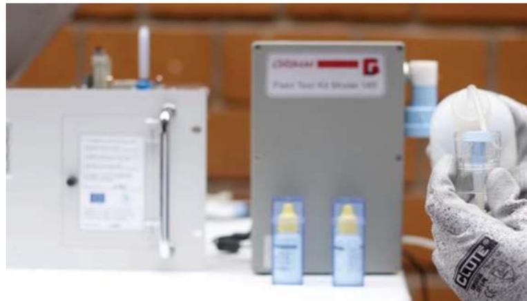
2.6.4. Luego para el frasco de 1um echar 4 gotas del estándar de 1um y en el frasco de 2.5um echar 8 gotas del estándar de 2.5um y ambos frascos homogeneizar frotando horizontalmente cada frasco.
