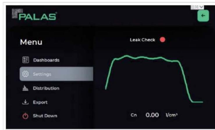
Imagen N° 19. Inicio de la comprobación de fugas del Equipo Fidas Smart 100E
