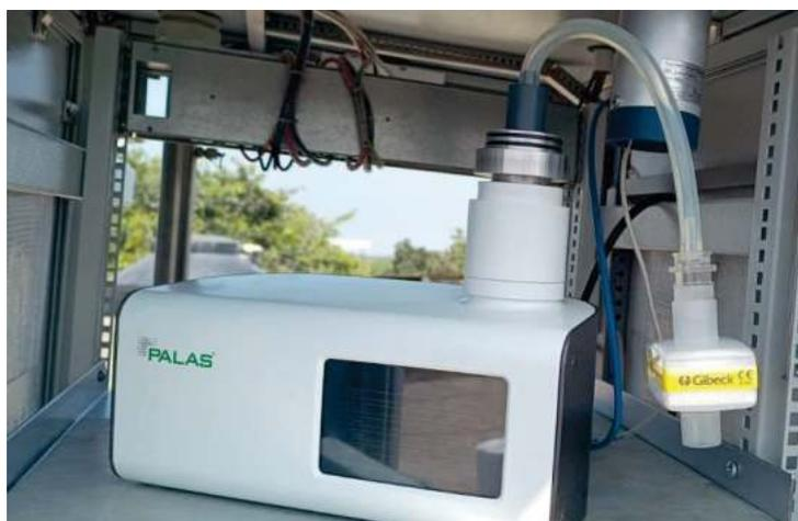
Imagen N° 21. Equipo Fidas Smart 100E con filtro HEPA
