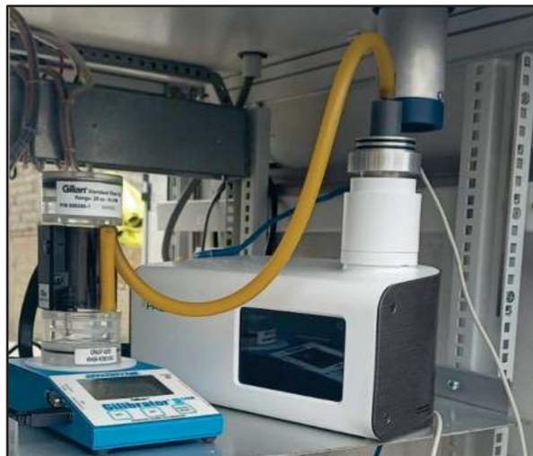
Imagen N° 9. Verificación de flujo del Equipo Fidas Smart 100E
