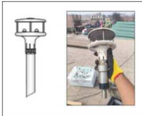
Figura 5. Montaje del Anemómetro en mástil
