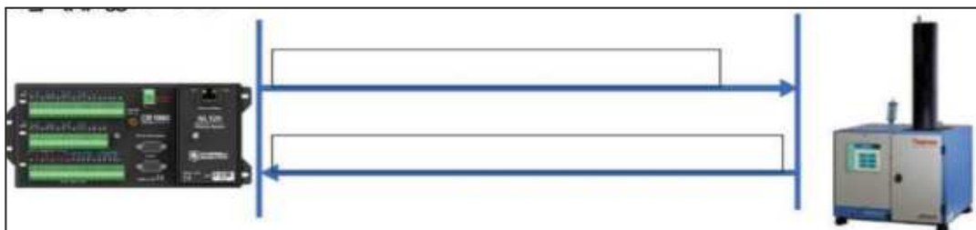
Figura 3. Ejemplo de recolección de la concentración promedio de 30 minutos de un equipo TEOM, desde un data logger.
