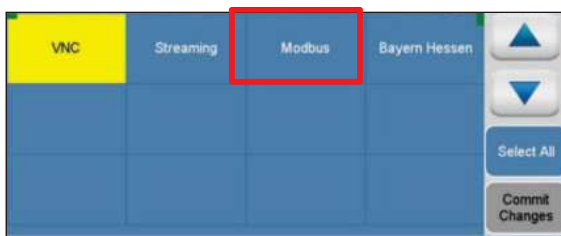
Figura 6. Habilitar opción Modbus en los analizadores
