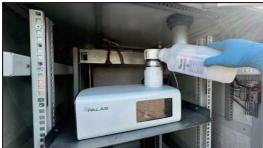
Figura 24. Verificación del Equipo Palas marca Fidas Smart 100E con MonoDust 1500
