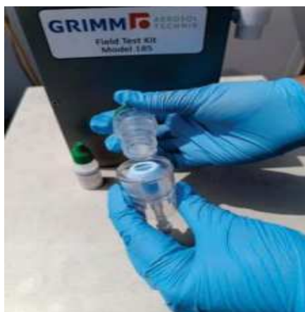
Figura 57. Vertimiento desde frasco de preparación a depósito que se conectará al Atomizador.
