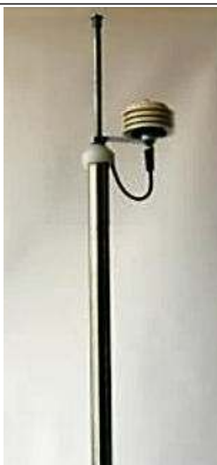
Figura 3. Tubo de muestreo, Sensor de Temperatura Ambiental y Humedad Relativa
