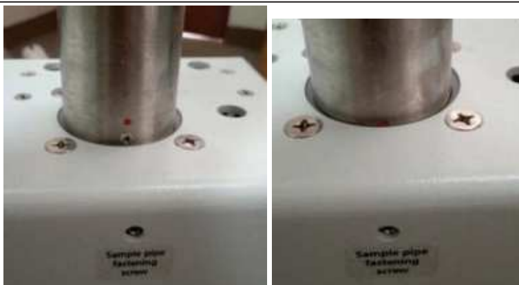
Figura 12. Alineamiento de tubo de muestreo para ingreso a su soporte.
