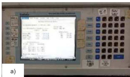
Figura 4. a) calibrador por dilución de gases, b) generador de aire cero
