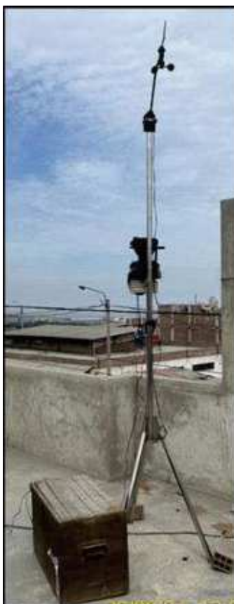
Figura 6. Estación meteorológica de la marca Davis instalada
