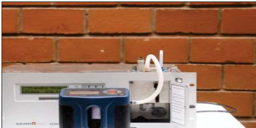
Figura 43. Conexión de Patrón de Flujo con Equipo Monitor
