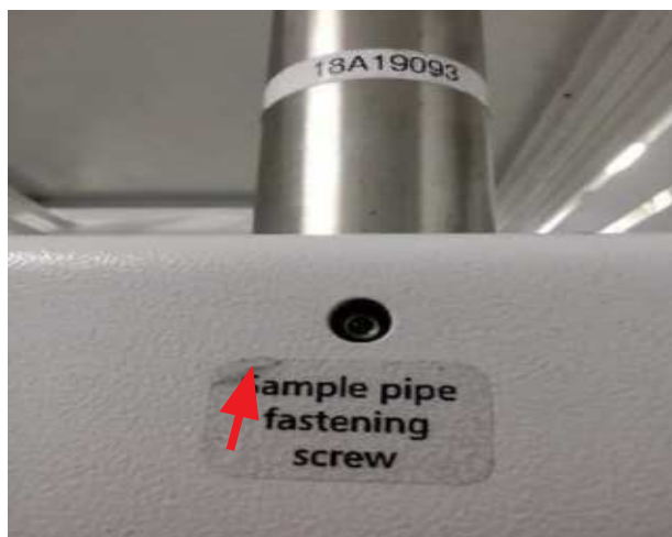
Figura 81. Muestra del “sample pipe fastening screw” o tornillo de fijación.
