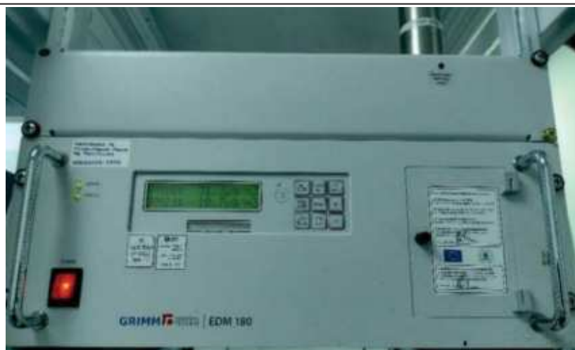
Figura 10. Monitor y Soporte instalado en Rack 19"
