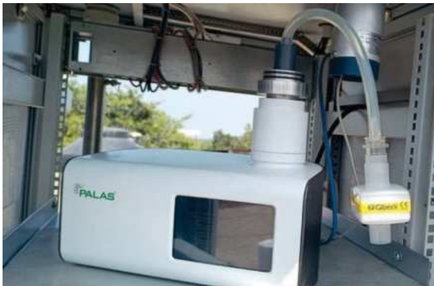
Figura 23. Equipo Fidas Smart 100E con filtro HEPA
