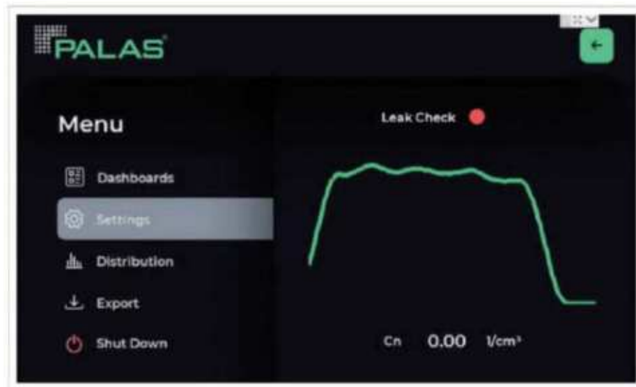
Figura 16. Inicio de la comprobación de fugas del Equipo Fidas Smart 100E
