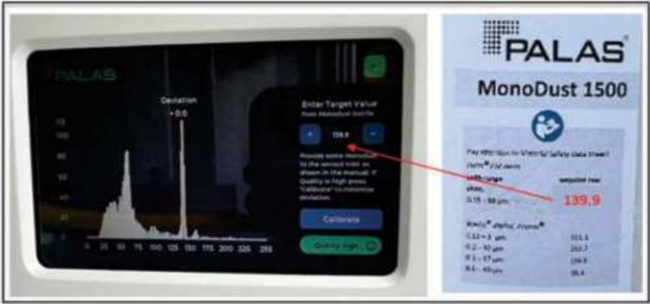
Figura 27. Inicio del ajuste del tamaño de partículas PALAS marca Fidas Smart 100E con MonoDust 1500
