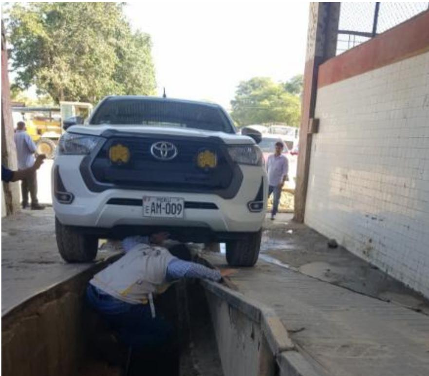
Se verificó la conformidad del tren motriz (motor, transmisión, eje de propulsión y diferencial), así como el correcto acoplamiento del sistema de tracción integral (4WD) mediante pruebas estáticas. Asimismo, se evaluó la integridad del sistema de suspensión, alineación de las ruedas, sistema de frenos ABS con distribución electrónica de frenado (EBD), dirección asistida y sistema de refrigeración.
