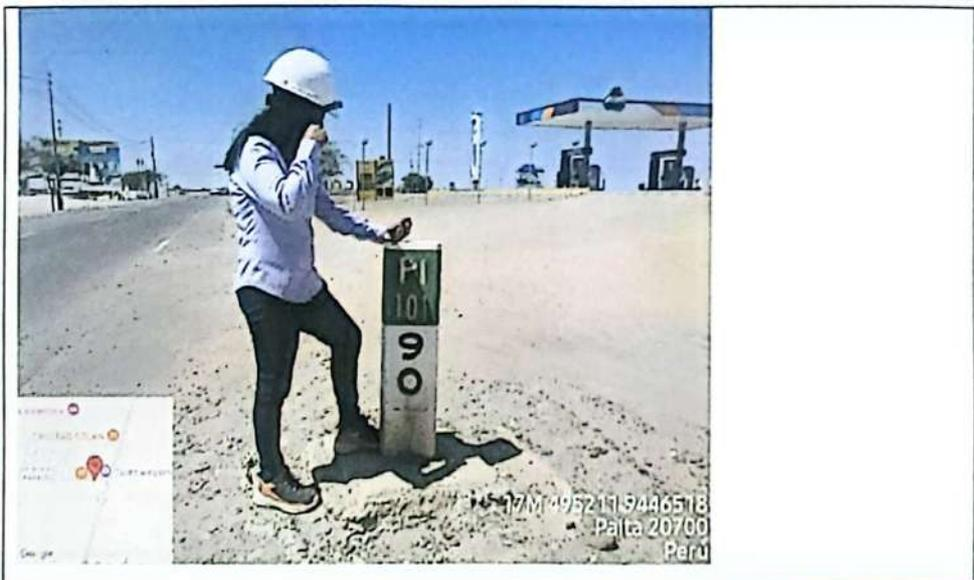
Imagen N°23: Verificación en campo de la señal de localización correspondiente al poste de kilometraje 90, empleando equipo GPS navegador
