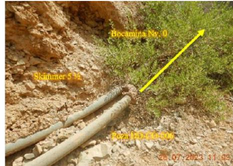
Fotografía N° 28<sup>57</sup>; Empalme del Skimmer 5 ½ con la poza del depósito de desmonte DD006.
