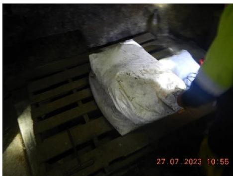
Fotografía N° 15<sup>44</sup>: Floculante utilizado en Cámara de Floculación ubicada interior mina en el Nv. 0.
