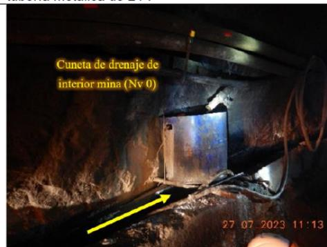
**Fotografía N° 14<sup>43</sup>:** Cuneta de drenaje de agua de mina, ubicada interior mina en el Nv. 0.
