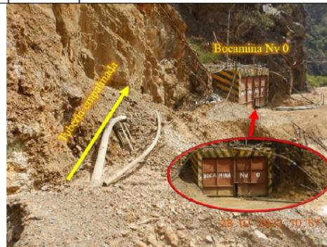
Fotografía N° 30<sup>59</sup>; Empalme del Skimmer 5 ½ con la poza del depósito de desmonte DD006 ingresando a la bocamina Nv. 0, para ser colectada por la tubería metálica de 24".
