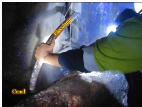
Fotografía N° 16<sup>45</sup>: En la captura de segundo 29 del video, se observó que el floculante era dosificado a través de tubería al canal interior del Nv. 0.
