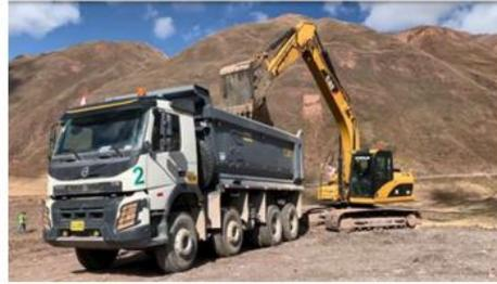
Fotografía N° 8: Vista de la maquina usada para transportar el suelo (top soil) desde el área de acopio en la unidad minera Casapalca.
