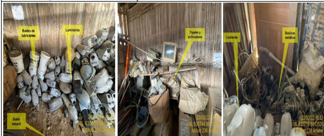
Fotografías N° 67, 69 y 71 del Informe de Supervisión 2022: En el área 4 se observa el almacenamiento de residuos peligrosos, como: baldes y envases vacíos de lubricantes; residuos no peligrosos, como: papelería, archivadores, llantas; RAEE, como: monitor de PC, carcasas de luminarias, medidores eléctricos y otros.
