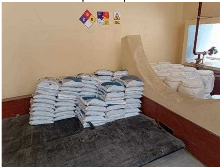
Imagen N° 27: Almacenamiento de productos químicos: Sulfato férrico – PTAP Cata Catas
