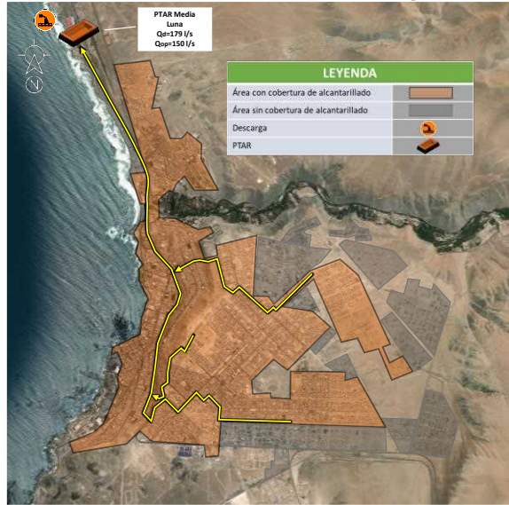
Imagen N° 5: Cobertura de Tratamiento de aguas residuales
