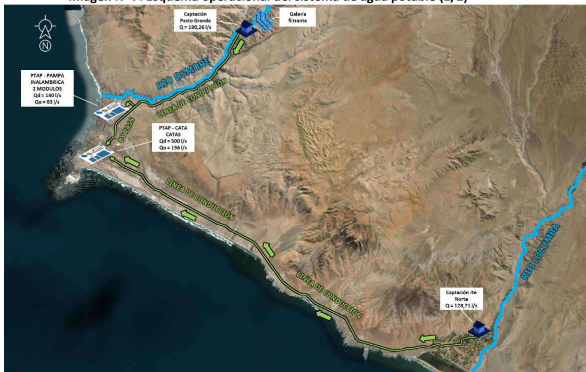
Imagen N° 7: Esquema operacional del sistema de agua potable (1/2)
