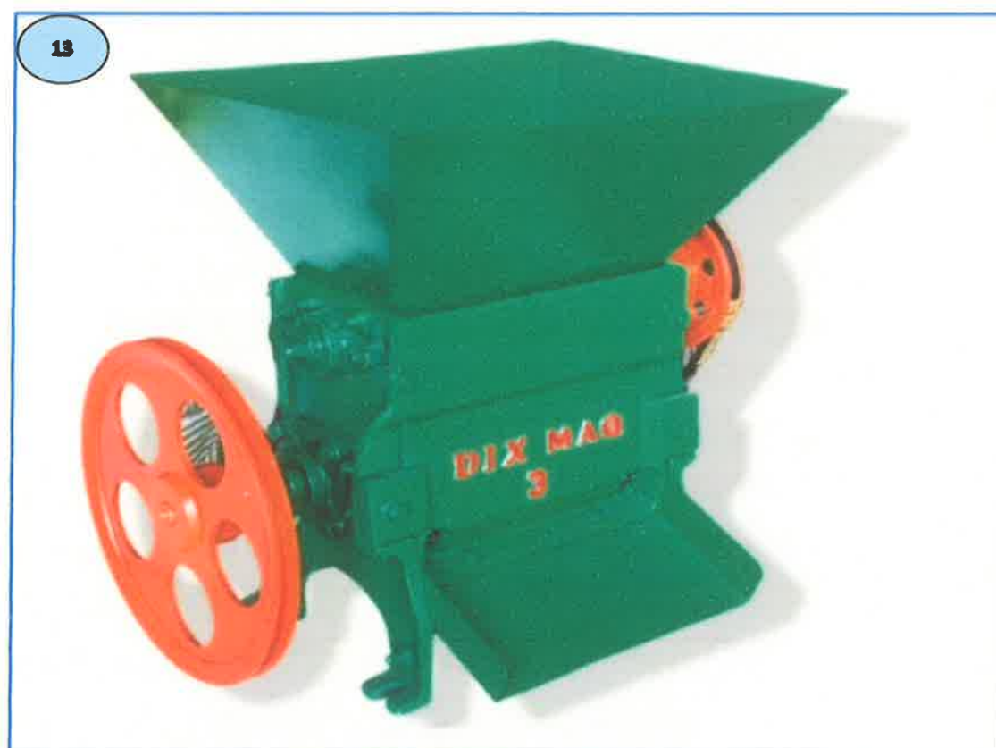
13: Modelo de despulpadora DIX MAC NRO 4 a implementarse en la comunidad.
