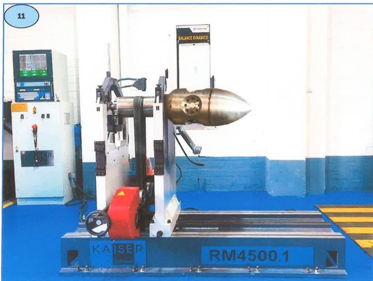
10 al 11: Prueba de Turbina Kaplan 40KW.
