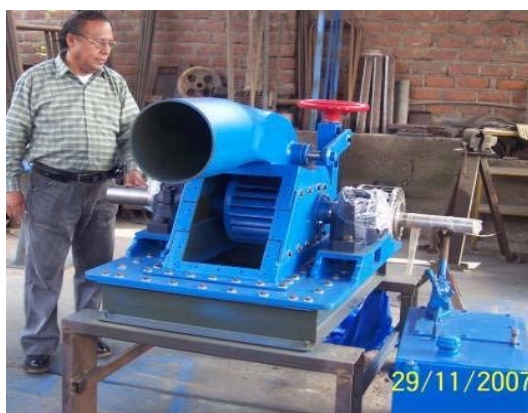
Prueba de turbina hidráulica Ampliación Minicentral Hidroeléctrica Conchán Provincia de Chota, Departamento de Cajamarca
