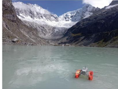
Figura 1. Pruebas de funcionamiento del bote batimétrico en la laguna Llaca, diciembre 2024.
