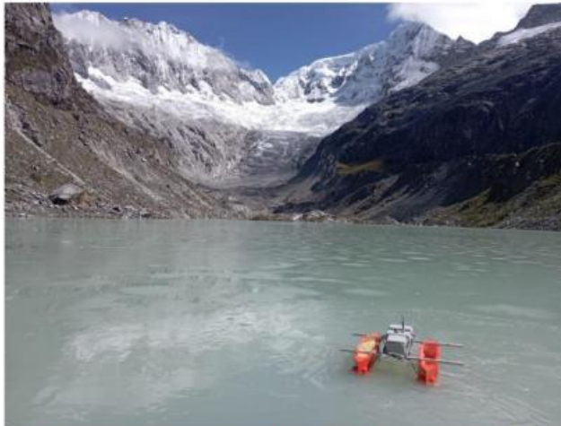
Figura 1. Pruebas de funcionamiento del bote batimétrico en la laguna Llaca, diciembre 2024.
