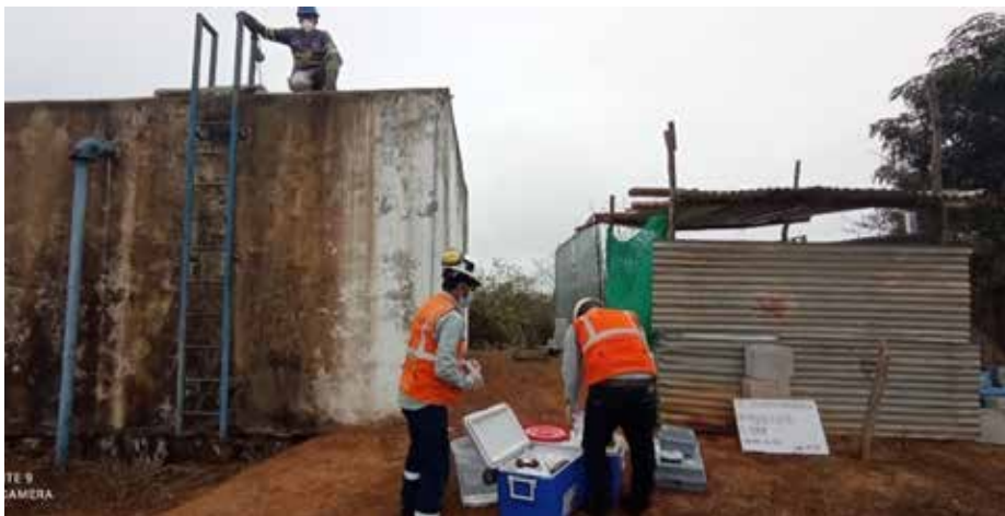
Imagen 19. Toma de muestra de agua en redes de distribución
