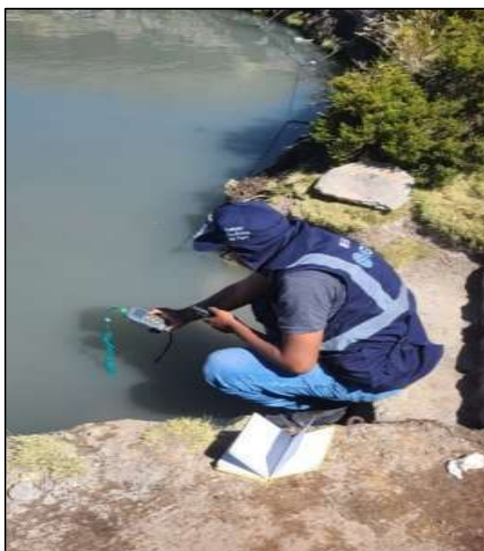
Figura 11.-Instalación del termómetro, medición de temperatura y toma de coordenadas de la fuente.
