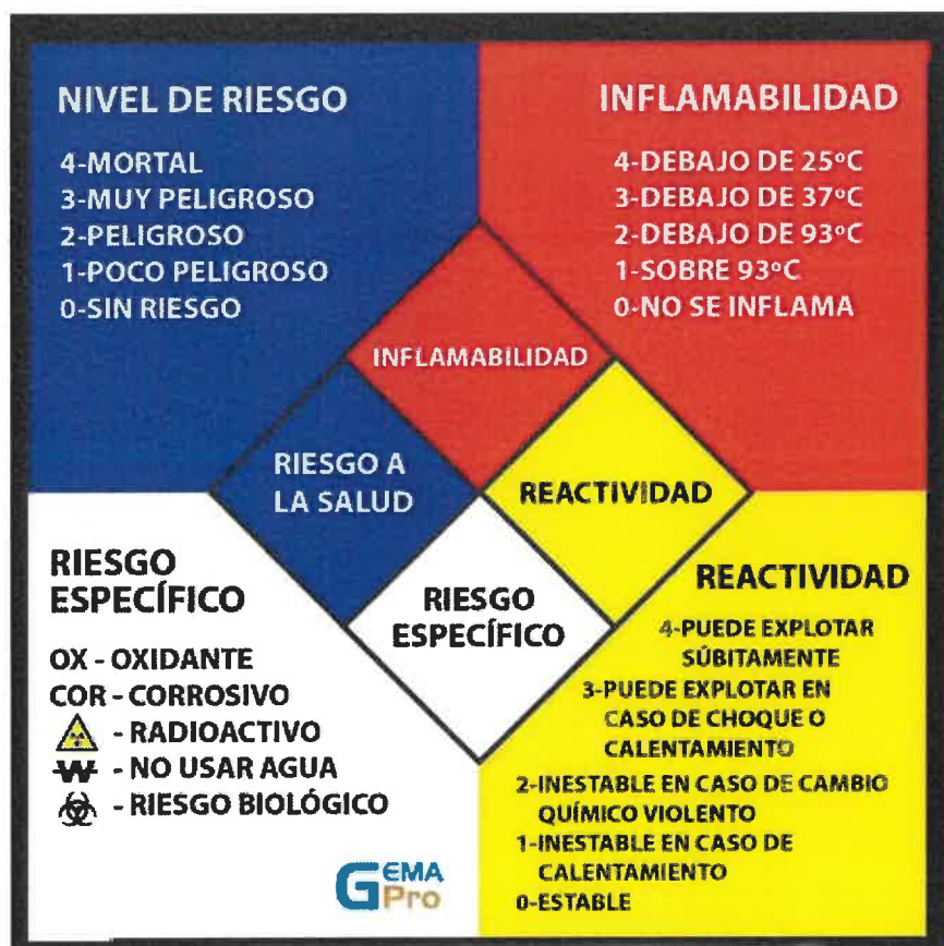
Figura 10: Rombo de seguridad NFPA
