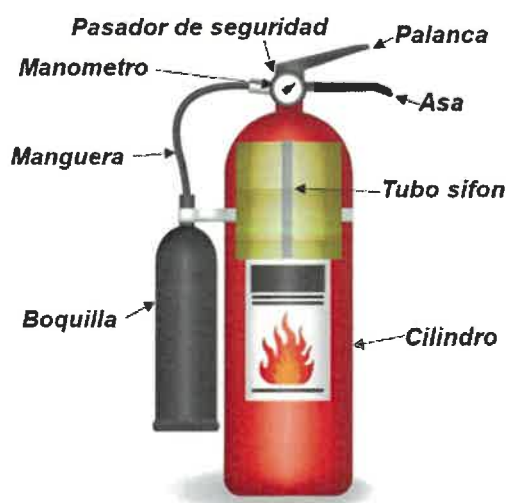
Figura 15: Partes del Extintor
