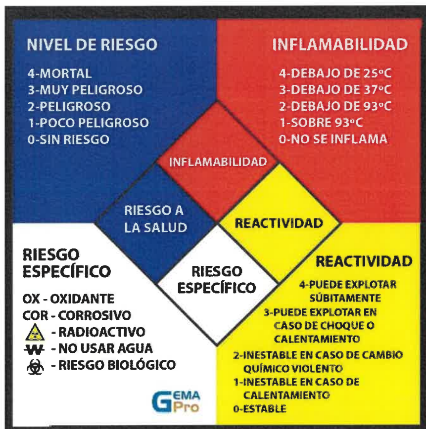
Figura 10: Rombo de seguridad NFPA
