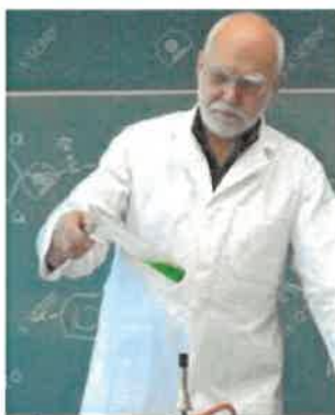
Figura 5: Ilustración mostrando la dirección del tubo de ensayo al ser calentado
