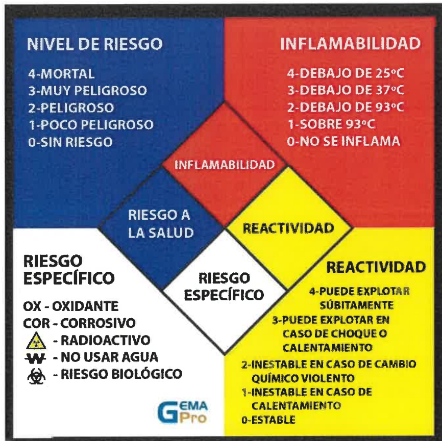
Figura 10: Rombo de seguridad NFPA
