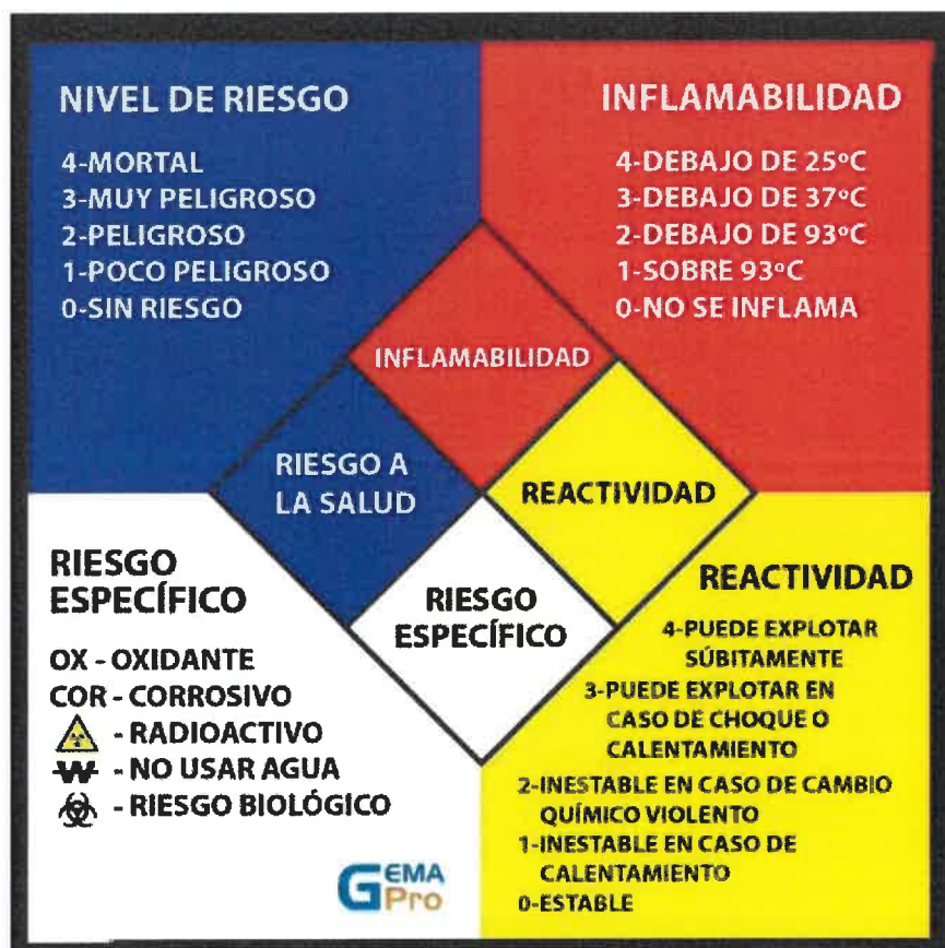
Figura 10: Rombo de seguridad NFPA
