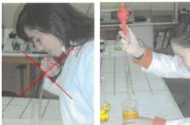
Figura 6: Ilustración mostrando la manera correcta de aspirar líquidos (pipetear)
