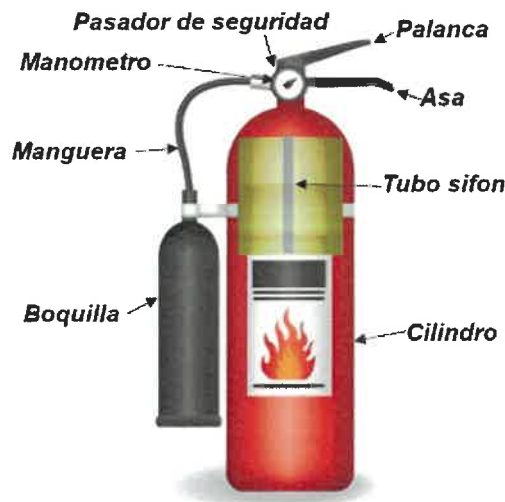
Figura 15: Partes del Extintor
