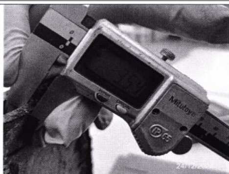
Fig. N°03: Espesor de caucho de nitrilo lado A. (3.54mm)
