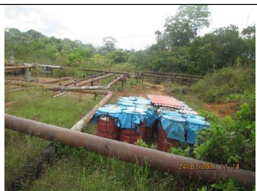
Fotografía N° 37: Se observa 24 cilindros metálicos en el área del derrame conteniendo residuos peligrosos, sobre suelo natural sin impermeabilización, sin contención y sin techo
