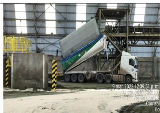
FOTOGRAFÍA N° 4.- Se observa el camión encapsulado que se prepara para la descarga de concentrado de cobre.
