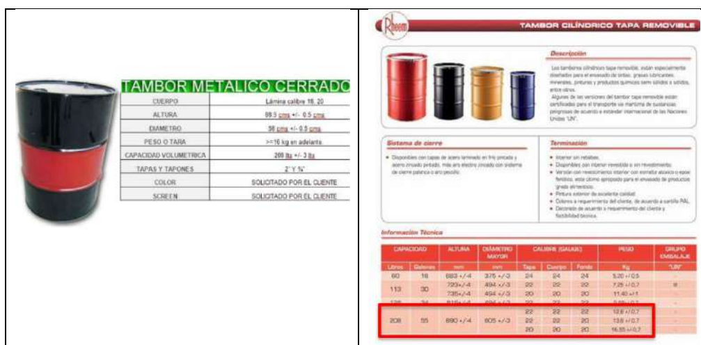
Imagen n.º 5: Ficha técnica de referencia para determinar el dimensionamiento de cilindros
