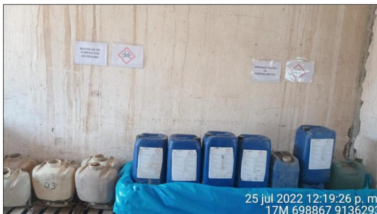
Imagen 4. Residuos Peligrosos almacenados en el Almacén de Residuos Peligrosos de la EMPRESA AGRÍCOLA SINTUCO conforme al ítem b) y f) distribuir los residuos de acuerdo a su compatibilidad física (tóxicos y corrosivos con compatibles).
