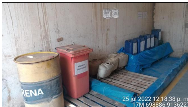
Imagen 5. Residuos Peligrosos almacenados en el Almacén de Residuos Peligrosos de la EMPRESA AGRÍCOLA SINTUCO conforme al ítem c) y d) con sistema de contención, con pasillo que permita el desplazamiento de personal y piso de material resistente (piso cemento).
