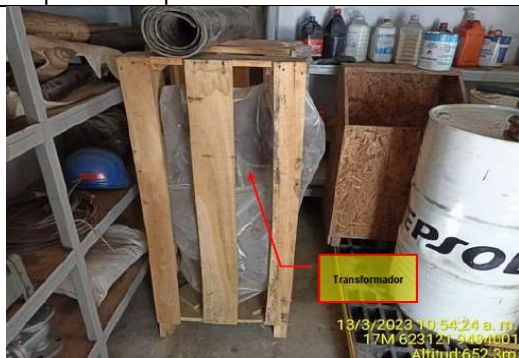
Fotografía N° 41 del Informe de Supervisión: Transformador dispuesto sobre parihuela, y este sobre el piso.
