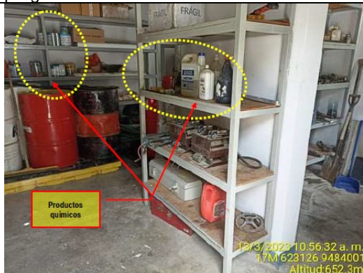
Fotografía N° 29 del Informe de Supervisión: Residuos oleosos almacenados juntamente con los productos químicos.
