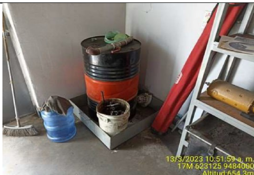
Fotografía N° 39 del Informe de Supervisión: Sustancias peligrosas sobre bandeja metálica de contención.
