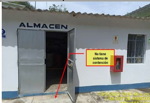
Fotografía N° 26 del Informe de Supervisión: Vista general del almacén de residuos sólidos peligrosos, sin sistema de contención.
