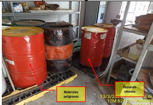
Fotografía N° 27 del Informe de Supervisión: Residuos oleosos juntamente con las sustancias peligrosas.
