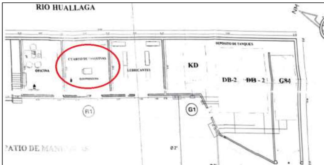
Imagen N.º 3. Ubicación del compresor en el cuarto de máquinas
