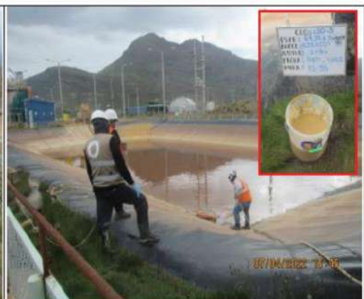
Fotografía 43. Vista de la toma de muestra del lodo en el punto LOD-3, interior de la poza de captación. (Fuente: fotografía IMG_6300).
