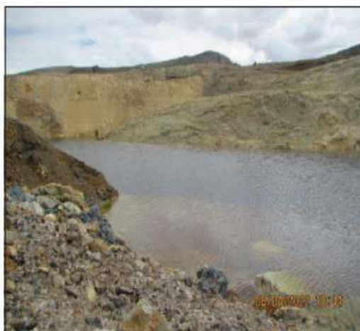
Fotografía 5. Vista de la acumulación de agua ácida en el interior del Tajo abierto, donde se muestreo el punto ESP-7 (Fuente: Fotografía IMG_3841).
