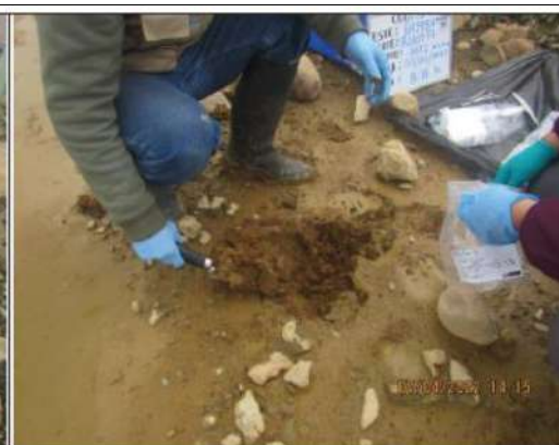
Fotografía 39. Vista de la toma de muestra de suelo realizada en el punto SU-PA02, lado este de la poza de captación. (Fuente: fotografía IMG_6233).
