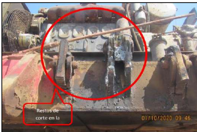
La figura muestra la chatarra con signos del oxicorte.
