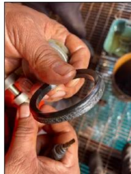
Figura N°4 y 5 Válvula Check de 2" y deterioro de los componentes internos
