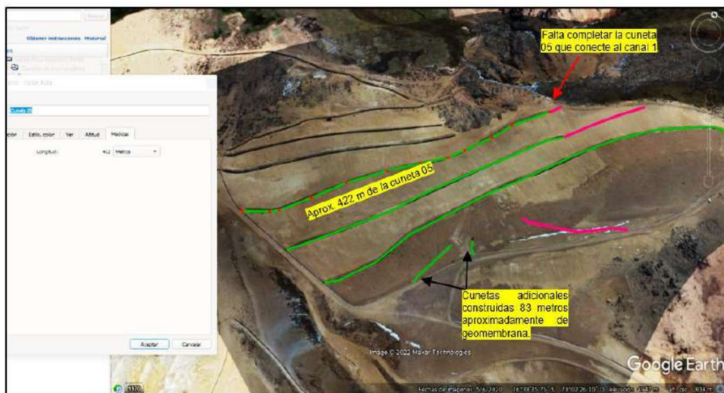
Gráfico N° 19. Vista de una cuneta 05 construida y no construida y cunetas construidas adicionales en el Botadero Norte
