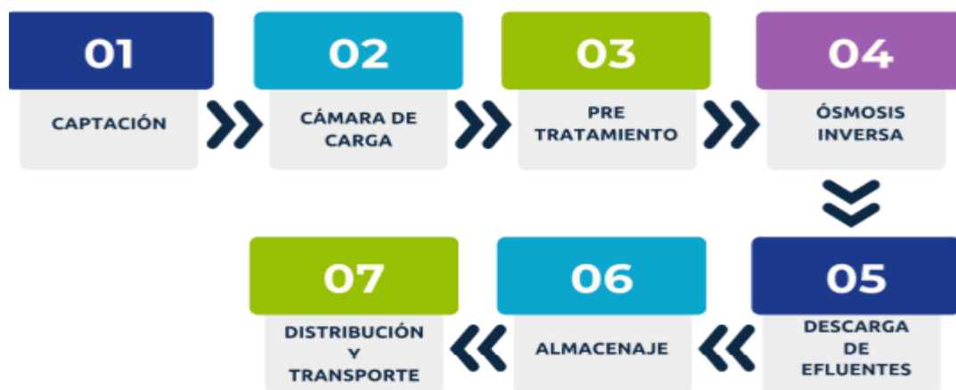
Figura N° 02 – Diagrama de Flujo del Nuevo Proceso Industrial Propuesto
