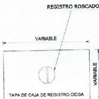
Detalle de tapa de caja de registro
